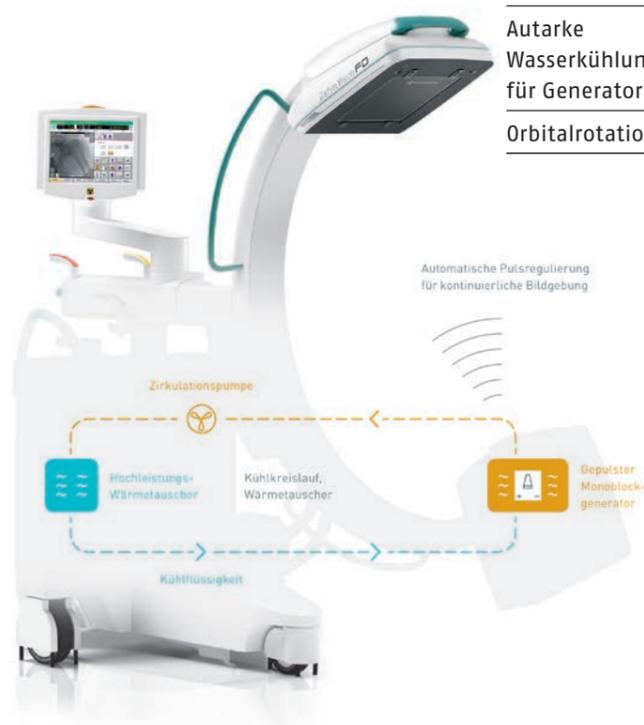
Die Advanced Active Cooling Technology der Vision-Familie hält die Generatortemperatur durch die automatische Anpassung der Pulsfrequenz und der leistungsstarken Flüssigkeitskühlung konstant.
