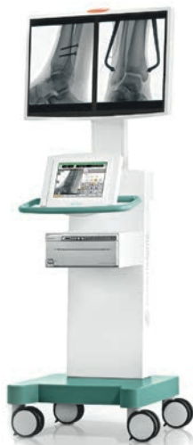
Der C-Bogen kann mit einer zusätzlichen Viewing Station (wired oder wireless) erweitert werden.
