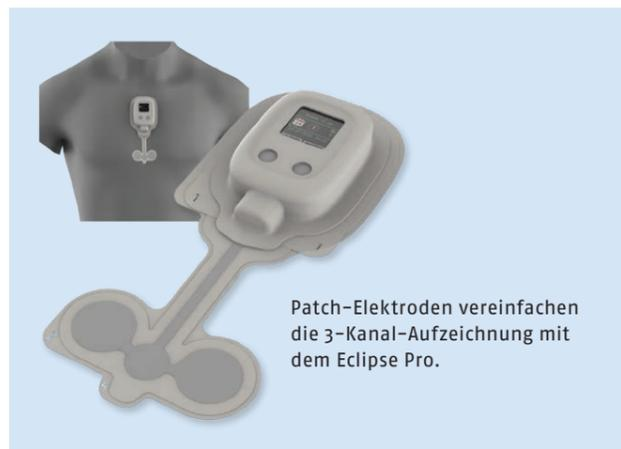
Patch-Elektroden vereinfachen die 3-Kanal-Aufzeichnung mit dem Eclipse Pro.
