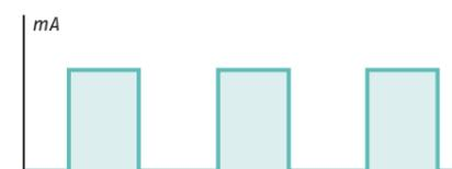
Kurze, scharf abgegrenzte Pulse minimieren die Dosis und maximieren die Bildqualität.
