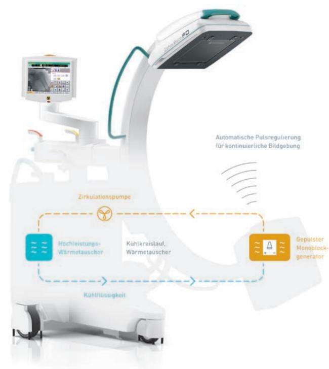
Die Advanced Active Cooling Technologie der Vision-Familie hält die Generatortemperatur durch die automatische Anpassung der Pulsfrequenz und der leistungsstarken Flüssigkeitskühlung konstant.
