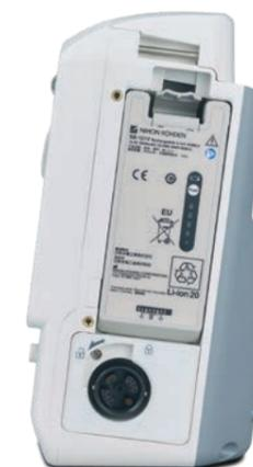
Eine Batterie für 6 Stunden Monitoring, 3.5 Stunden Pacing und 200 Schocks zu 270J (mit neuer Batterie).
