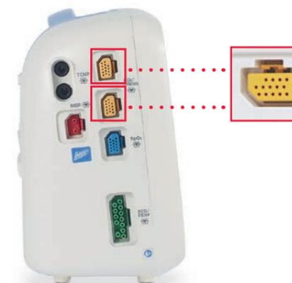
Vismo PVM-4763 mit zwei Multikonnektoren für den Anschluss von CO<sub>2</sub>/IBP.
