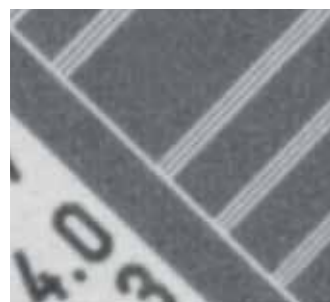
Räumliche Auflösung mit mehr als 4.0 lp/mm
