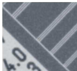
Räumliche Auflösung mit mehr als 4.0 lp/mm
