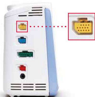
Vismo PVM-2703 mit einem Multikonnektor für den Anschluss von CO 2 /IBP.
