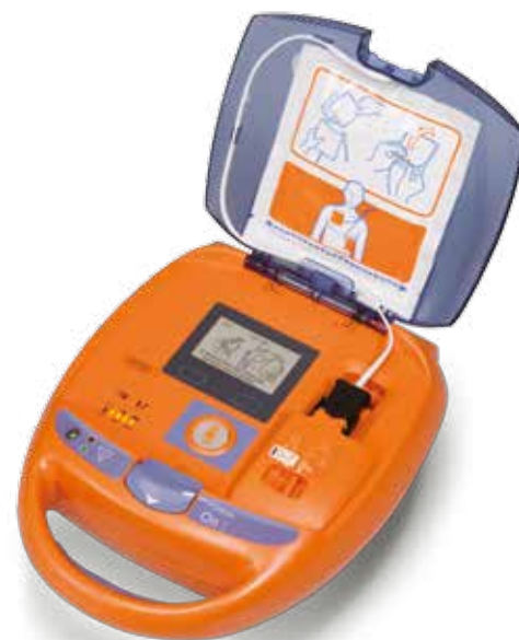
Die AED-2150 Serie ist mit einem Display ausgestattet, auf welchem wahlweise die Onscreen-Reanimationsanleitung und/oder die halbautomatische VF-Analyse ersichtlich ist.
