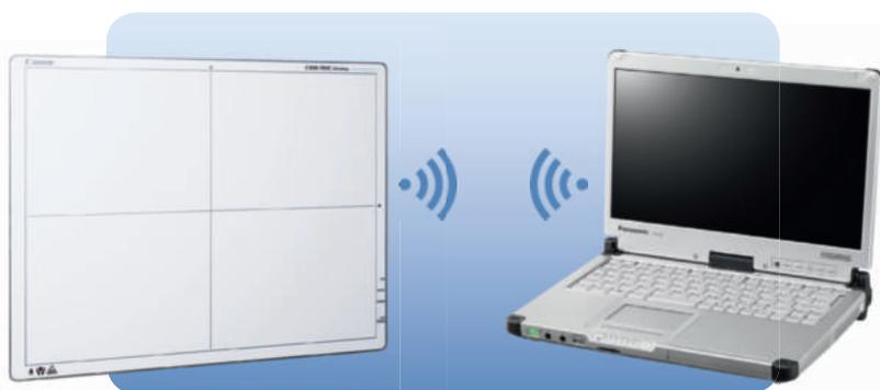
Entscheidend für die schnelle Akzeptanz und den grossen Erfolg der Retrofit-Lösung von Canon ist die Einfachheit. Mit nur zwei Komponenten, Detektor und Akquisitionskonsole, kann jede Röntgenanlage in weniger als zwei Minuten auf DR nachgerüstet werden. Ohne Eingriff in das bestehende System dank **autodetect Retro-**
