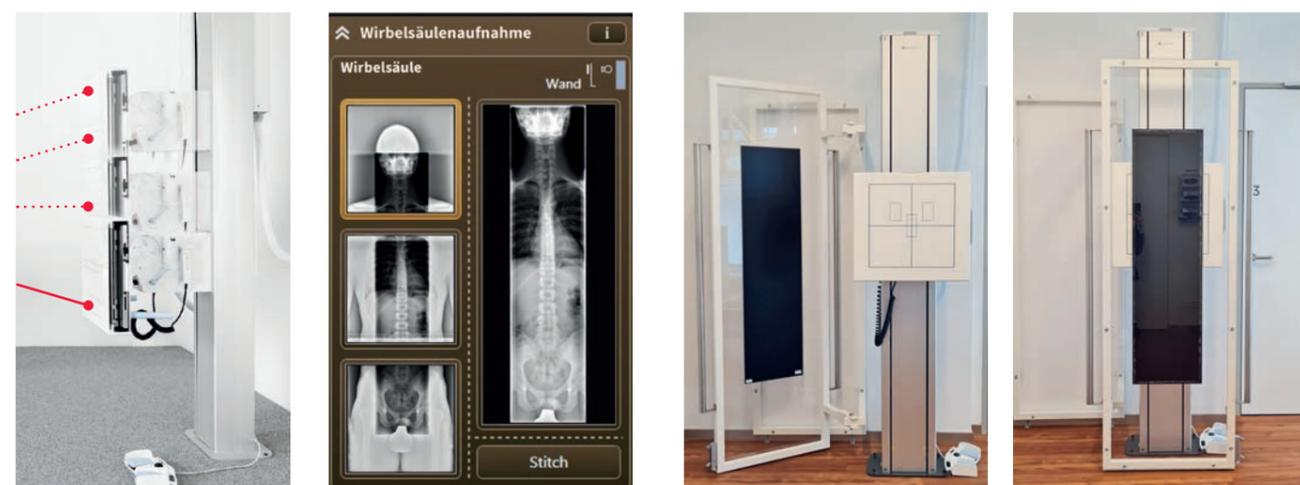
*Le Stitching est totalement intégré et automatisé dans l'interface utilisateur. Le système de radiographie facilite le réglage graphique, calcule automatiquement le nombre requis de clichés (max. 4) et procède à l'enregistrement automatique de toutes les images. L'option « One Shot Stitching » est également proposée.*
