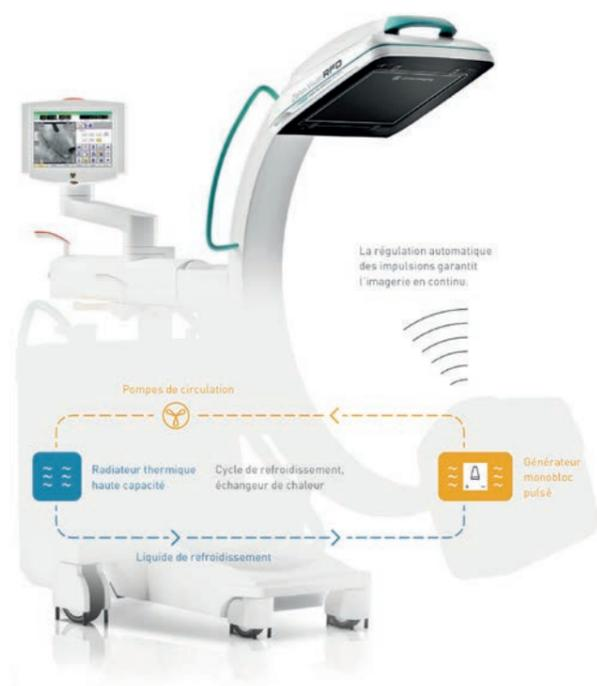
La technologie Advanced Active Cooling pour tous les systèmes Vision maintient la température du générateur constante, avec un puissant refroidissement liquide en circuit fermé et en ajustant automatiquement la fréquence des impulsions de la fluoroscopie.
