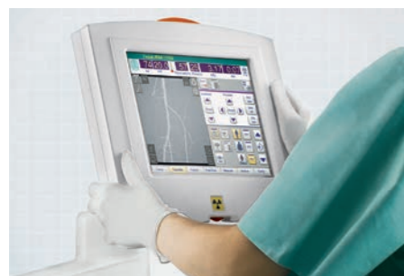
Ziehm SmartEye ermöglicht eine Live-Darstellung der Durchleuchtung auf dem TFT Touchscreen
